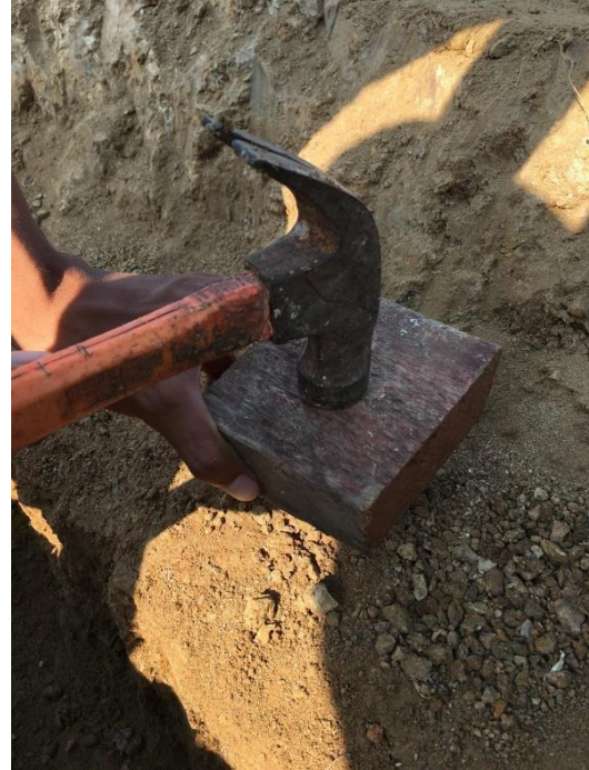
(b) Pemasangan Ring Sampel
