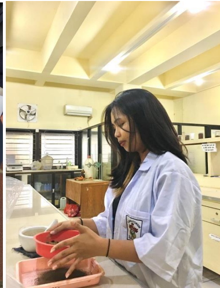
(d) Penyiapan tanah terusik
