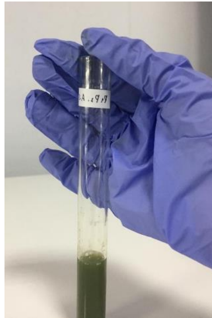
Perubahan warna pada uji kualitatif tanin setelah ditambahkan fecl 1%
