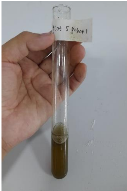
Perubahan warna pada uji kualitatif flavonoid setelah ditambahkan HCL
