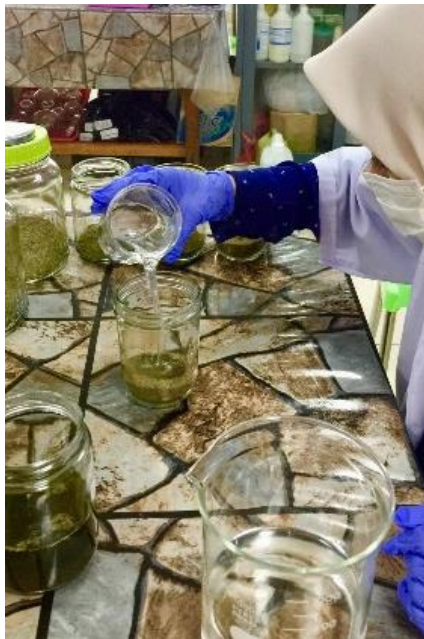
Sampel halus ditimbang 20 gr lalu dimaserasi dengan pelarut etanol 96% selama 3 hari
