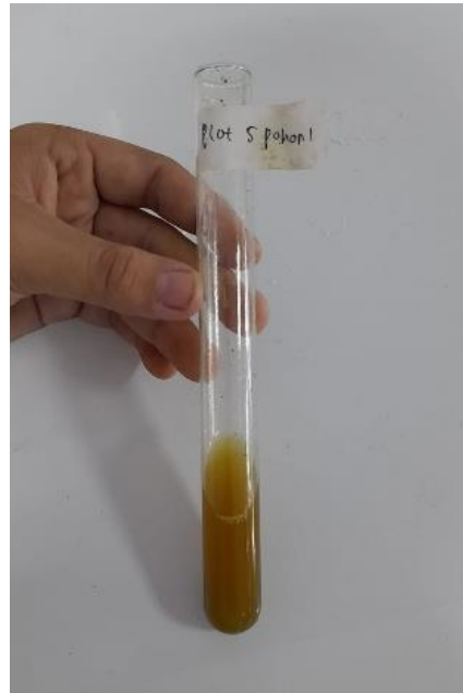
Perubahan warna pada uji kualitatif flavonoid setelah ditambahkan HCL
