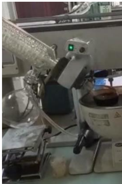
Hasil maserasi lalu dipekatkan menggunakan alat rotary evaporator disimpan ke dalam botol aluvial
