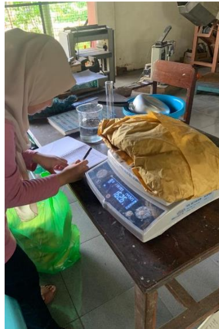
Sampel dioven dengan suhu 40°C lalu ditimbang
