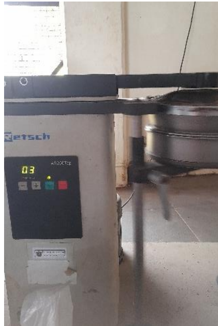
Sampel digiling menggunakan alat hammer mill lalu diayak dengan alat shieve shaker
