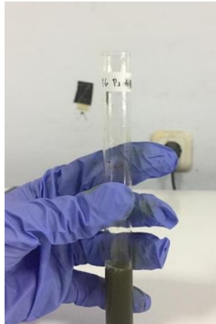
Perubahan warna pada uji kualitatif polifenol setelah ditambahkan fecl 1%
