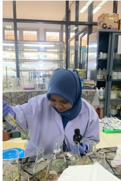
Perubahan warna pada uji kualitatif polifenol setelah ditambahkan fecl 1%
