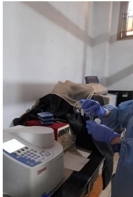
Uji kuantitatif pada sampel dan pengambilan nilai absorban
