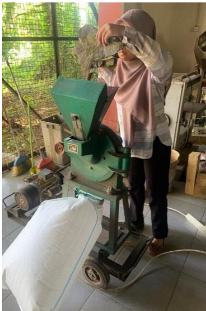
Sampel digiling menggunakan alat hammer mill lalu diayak dengan alat shieve shaker
