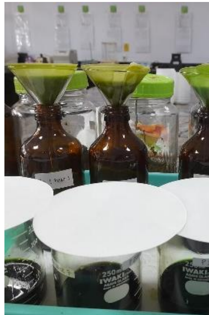
Sampel halus ditimbang 20 gr lalu dimaserasi dengan pelarut etanol 96% selama 3 hari
