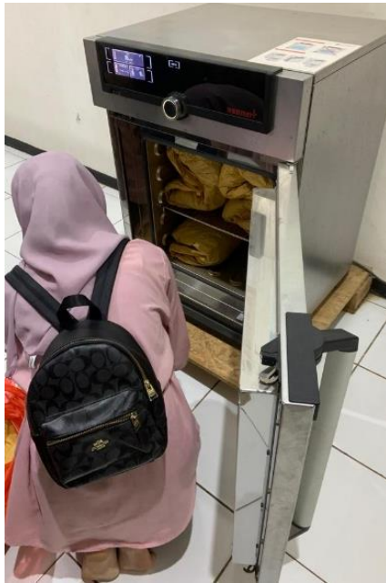
Sampel dioven dengan suhu 40°C lalu ditimbang
