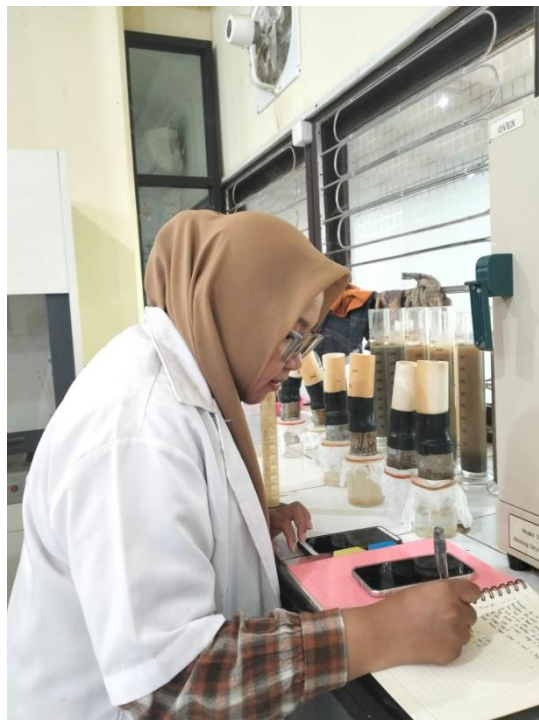
Pengujian permeabilitas tanah
