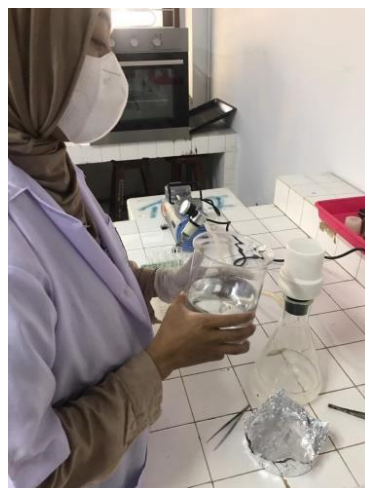
Gambar 20. Menyaring Sampel air Klorofil-a
