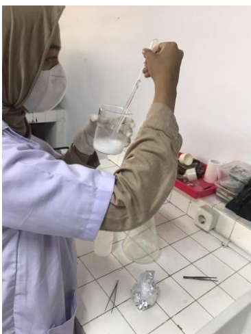
Gambar 19. Memasukkan Larutan MgO 3 pada Kertas Saring
