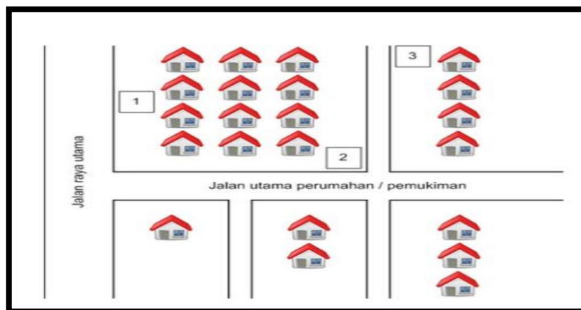
Gambar . Titik ukur peruntukan kawasan perumahan dan pemukiman dengan sumber bising utama dinamis
