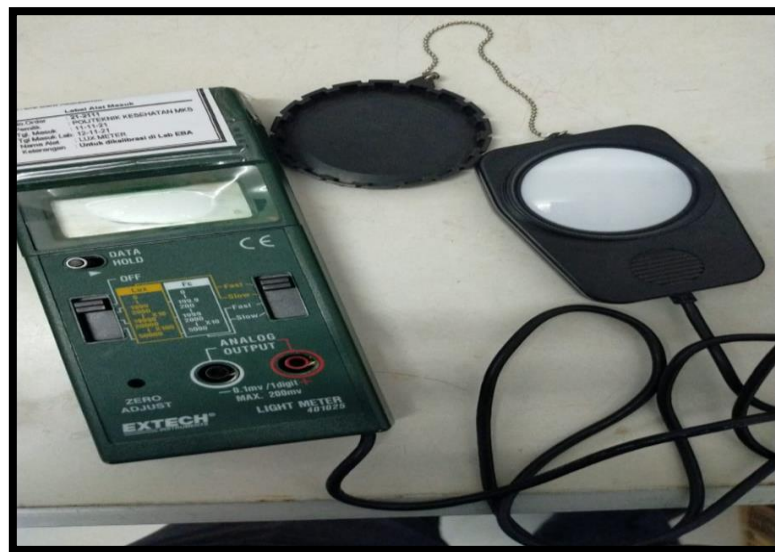
Gambar 3 Alat Ukur Pencahayaan (Lux Meter) Sumber : Poltekkes Kemenkes Makassar
