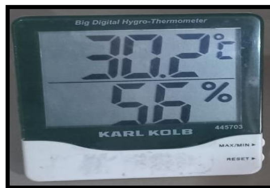
Gambar 2 Alat Ukur Kelembapan (Higrometer) Sumber : Poltekkes Kemenkes Makassar
