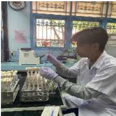
Sampel positif dimasukkan ke dalam media BGLB dan EC Mug menggunakan Ose Steril
