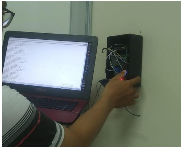
Gambar IV. 6 Pengujian *Fingerprint Sensor*.
