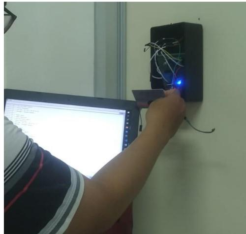
Gambar IV. 4 Pengujian *Delay Scan Smartcard* pada *Reader*
