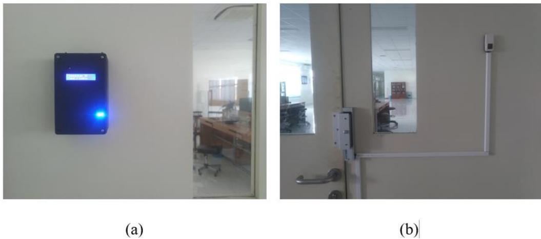
Gambar IV. 1 Hasil Perakitan Hardware, (a) Akses Masuk, (b) Akses Keluar
