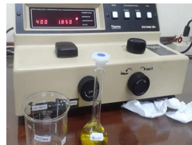
Uji Fosfor dengan instrument UV-VIS
