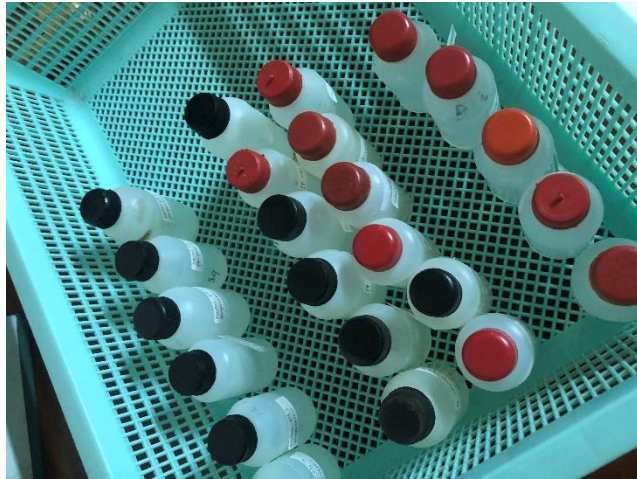
Gambar 7. Larutan yang akan diukur absorbansinya menggunakan SSA
