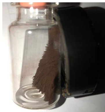
Gambar 3. Uji coba magnetit dengan magnet eksternal
