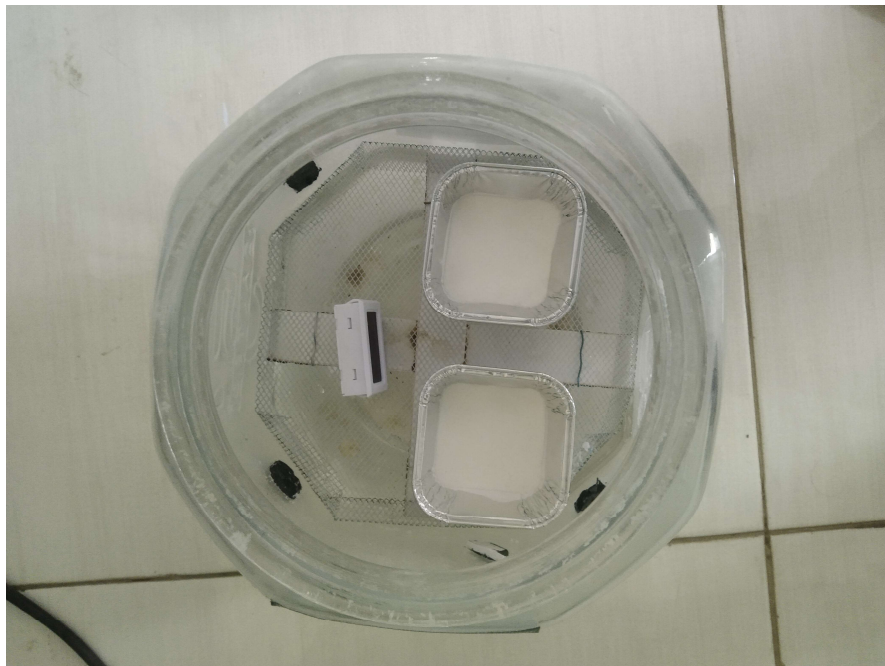
Penempatan sampel dalam wadah yang berisi larutan garam
