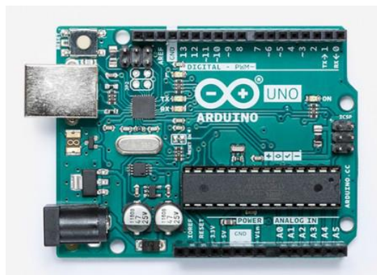
Gambar 2.1 Mikrokontroler arduino uno.
