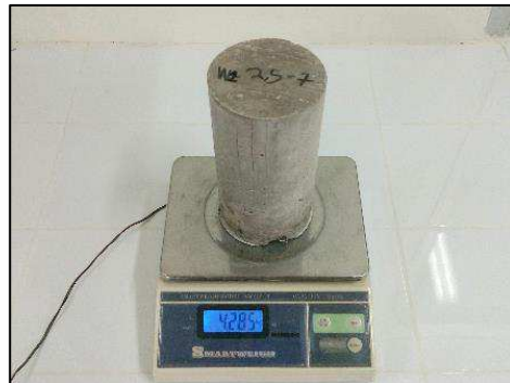
Pengujian berat benda uji
