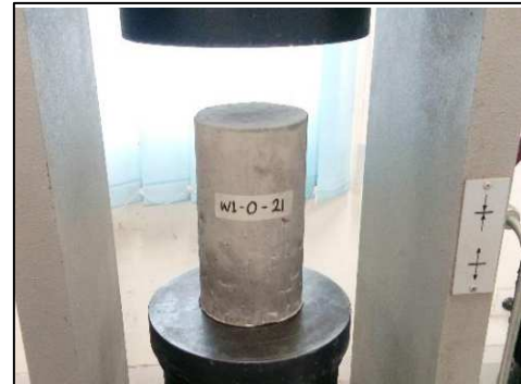
Pengujian kuat tekan (Sebelum ditekan)
