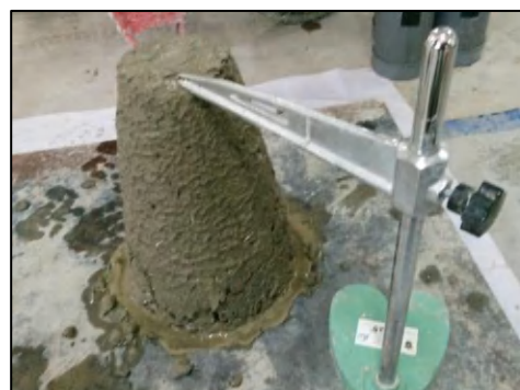
Pengujian Nilai Slump
