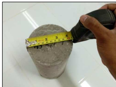
Pengukuran diameter benda uji
