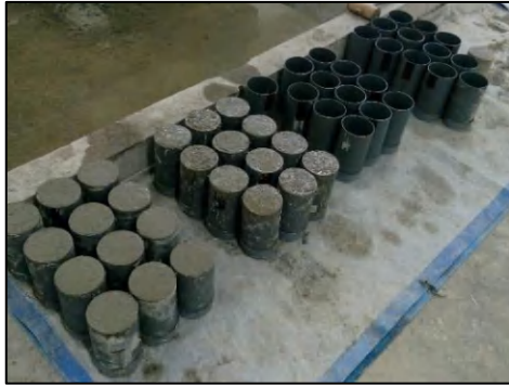
Pencetakan benda Uji
