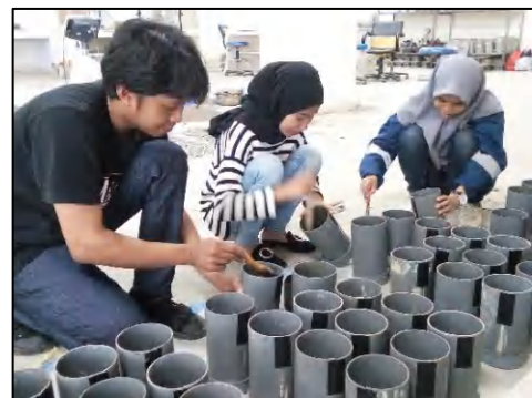
Pengolesan oli pada bekisting
