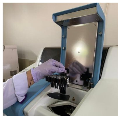
Pemeriksaan kadar kolesterol dan trigliserida menggunakan alat Thermo Scientific Indiko Automatic Analyzer .
