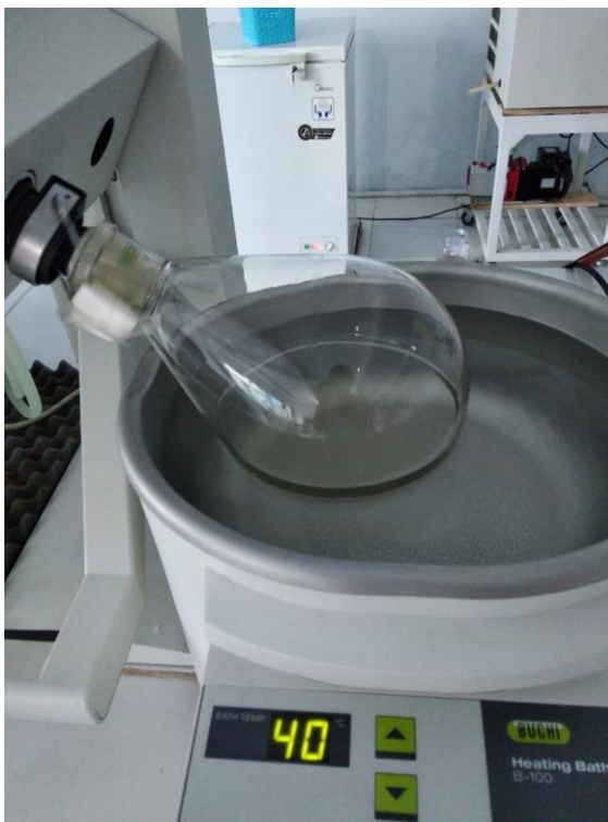
Dilakukan Rotavapor untuk memisah pelarut dan ekstrak
