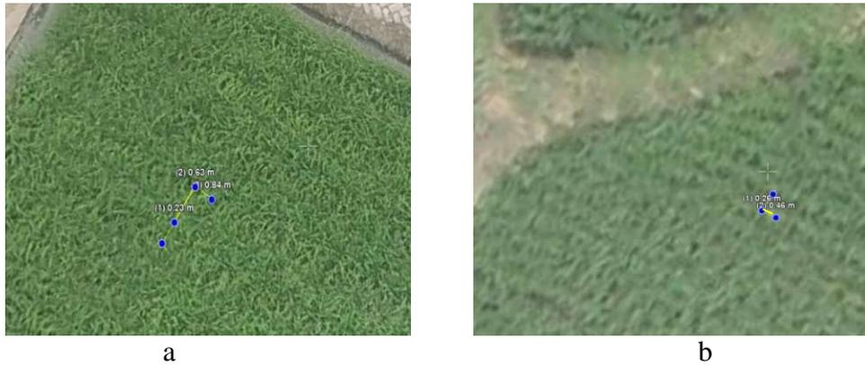
Gambar 12. Pengukuran Jarak Tanam menggunakan *Software Agisoft Photoscan* saat 19 HST pada: a. Petak 78 (pola tanam legowo 2:1), dan b. Petak 56 (pola tanam tegel).
