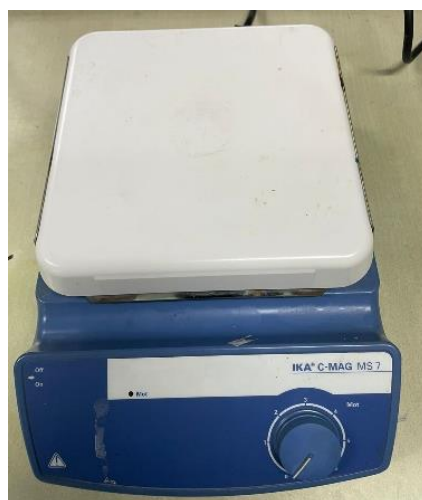
Gambar 23. Alat magnetic stirrer
