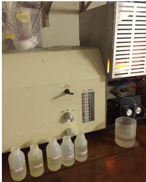
Gambar 18. Proses analisis sampel dengan menggunakan SSA
