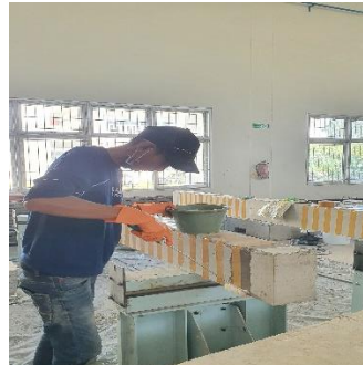
(h) Pengolesan epoxy resin ke permukaan balok
