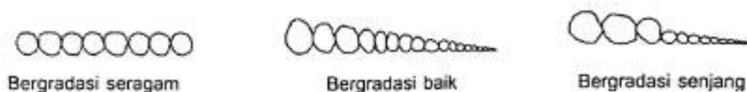
Gambar 2. Ilustrasi rentang ukuran butir pada berbagai gradasi
