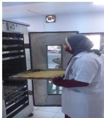
Lampiran 2c. Proses pengeringan menggunakan oven blower beras yang telah diekstruksi
