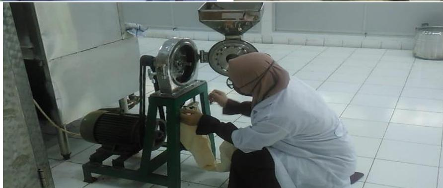
Lampiran 1b. Proses penggilingan menggunakan *disc mill*
