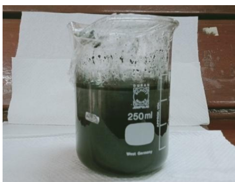
Aktivasi karbon tempurung kemiri dengan H_3PO_4
