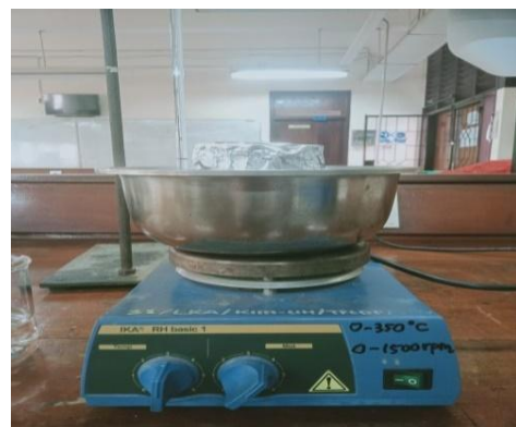
Deposisi nanopartikel MnO_2
