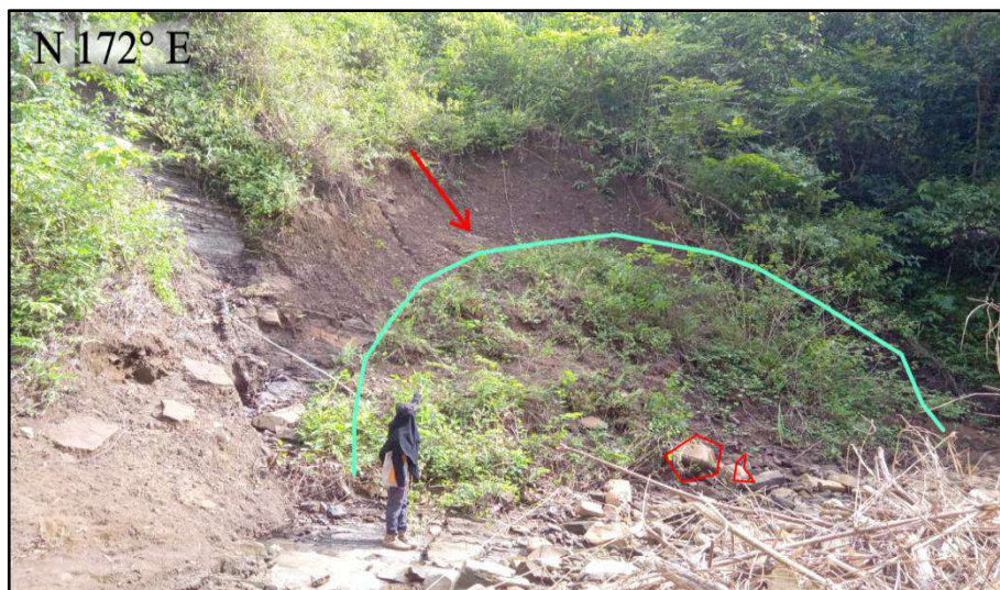
Gambar 9 Kenampakan massa batuan dan tanah hasil jatuhnya debris slide pada stasiun 71 Daerah Salo Keera dengan arah foto N 172° E
