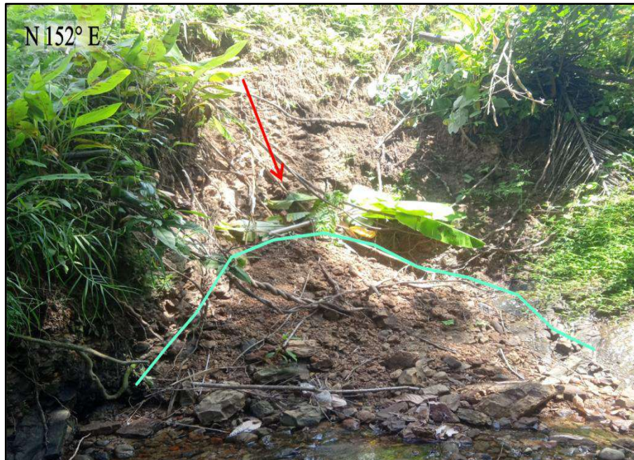
Gambar 17 Kenampakan massa batuan dan tanah hasil jatuhnya debris slide pada stasiun 22 Daerah Paselloreng dengan arah N 152° E
