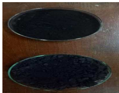
Karbon Aktif setelah Pengeringan pada Suhu 110\text{ }^\circ\text{C} selama 2 jam
