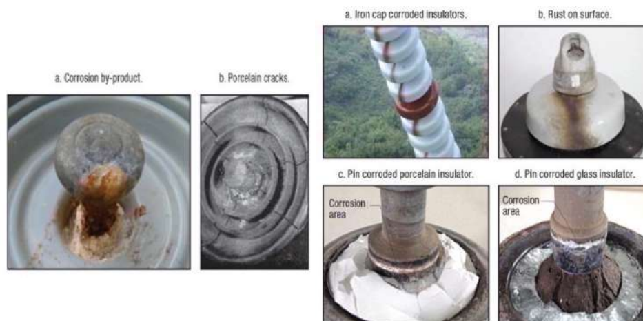
Gambar 8. Cangkang isolator yang retak dari penuaan
