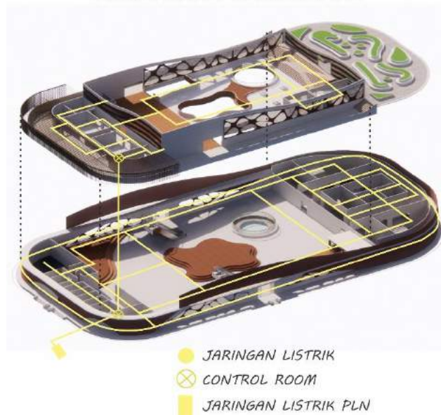
Gambar 2. 13 Sistem Mekanikal Elektrikal
