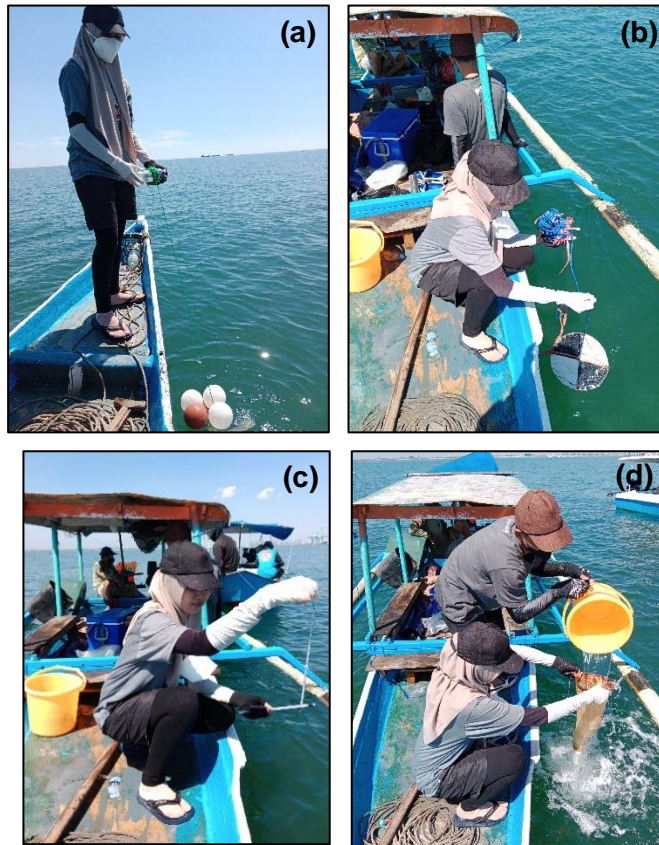
(a) pengukuran kecepatan arus; (b) pengukuran kecerahan; (c) pengukuran suhu; (d) pengambilan sampel fitoplankton.
