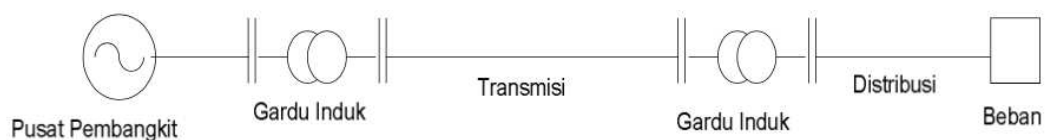
Gambar 1 Diagram satu garis sistem tenaga listrik (Lidya & Siregar, 2015)
