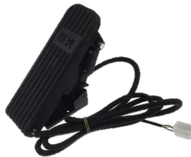
Gambar 11. Pedal gas elektrik
