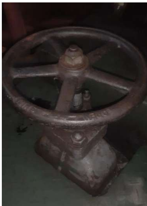
Gambar 4.7 Main valve Seachest jumlahnya 2 pcs, berada di bagian sebelah kiri dan kanan kamar mesin, posisinya sebelum masuk strainer/filter
