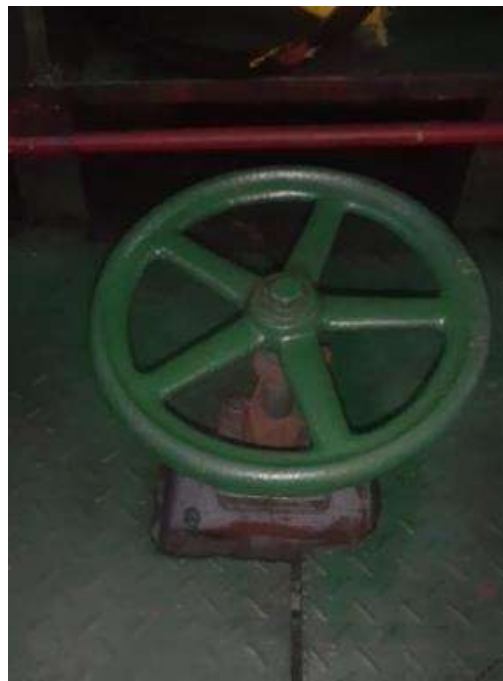
Gambar 4.6 Second Valve Seachest jumlahnya 2 psc posisinya berada dibagian tengah setelah strainer/filter Seachest
