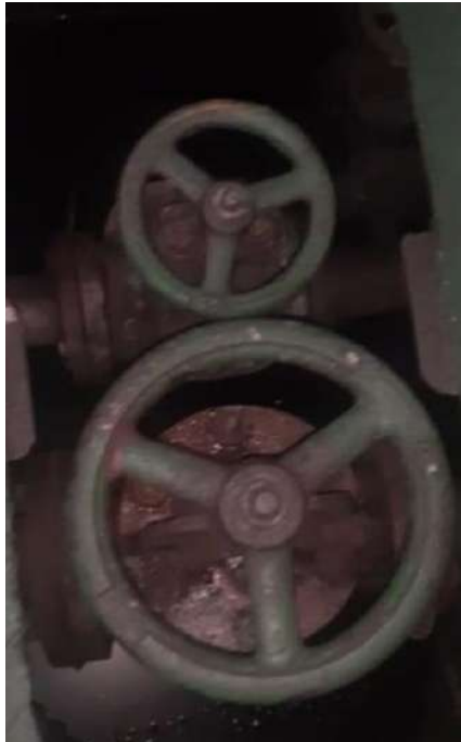
Gambar 4.9 Valve Sea Water cooler Main Engine dan Auxiliary Engine sebelahkanan dan kiri jumlahnya 2 pcs
