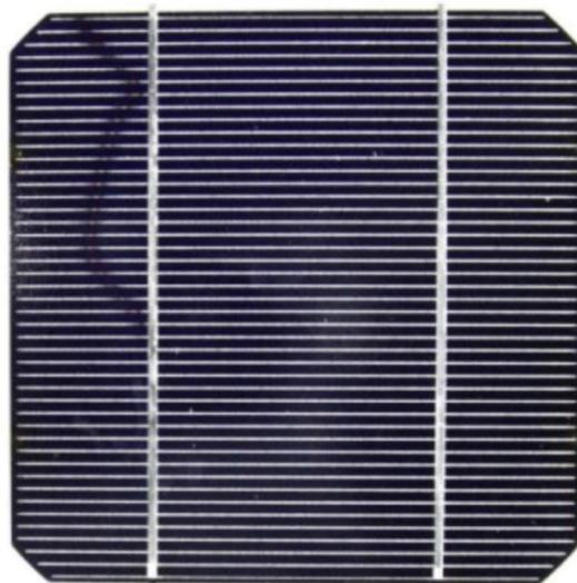
Gambar 2. 6 Penomena jejak siput atau *snail trails* yang terjadi pada permukaan panel surya [24].
