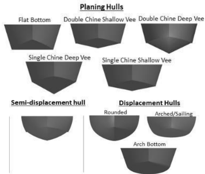
Gambar 2. 5 Bentuk-bentuk lambung kapal untuk kategori displacement hull, planing hull, semi-planing hull
