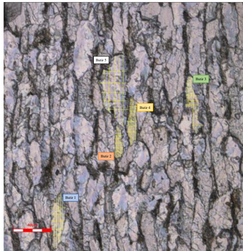
Lampiran D.2 Struktur mikro spesimen 8mm bagian A-tengah after creep
