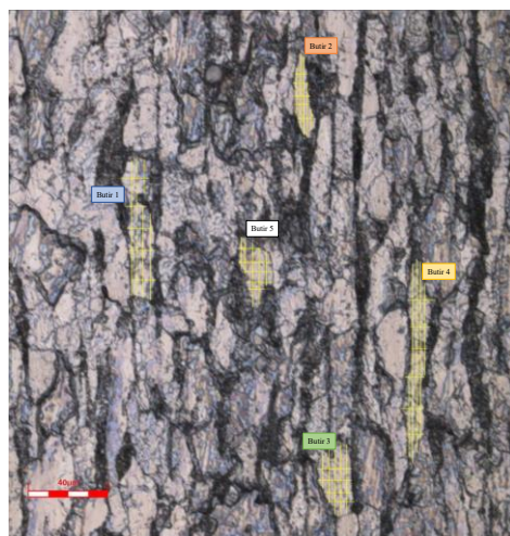
Lampiran D.3 Struktur mikro spesimen 8mm bagian A-bawah after creep
