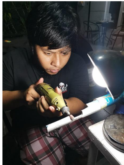
Lampiran F. 8 Proses penghalusan spesimen
