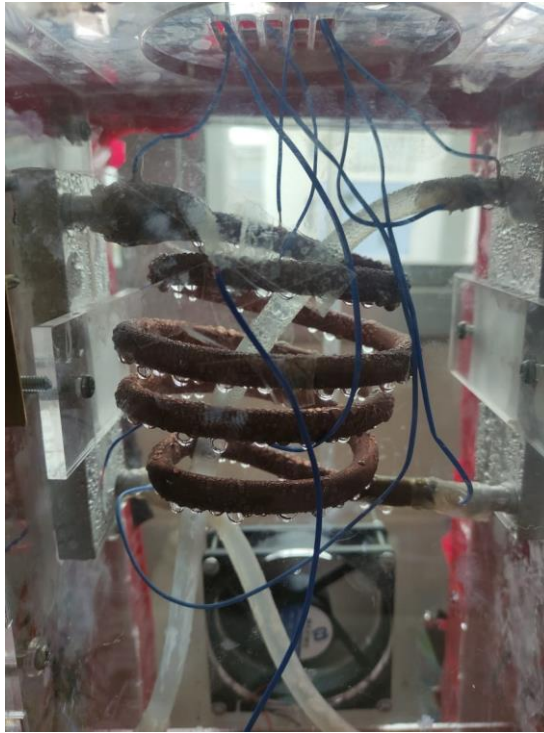
Lampiran 4 Kondensasi pada coil tembaga
