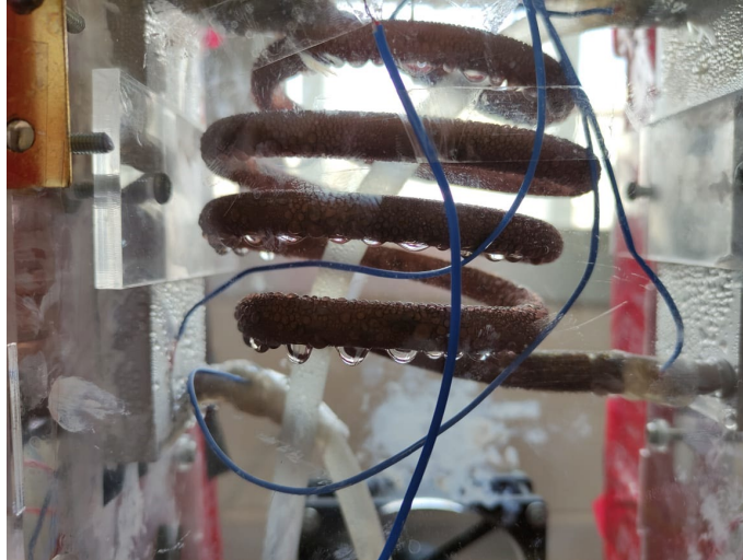
Lampiran 3. kondensasi air pada pipa tembaga
