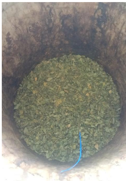
Foto pemasukan bahan kedalam ketel suling
