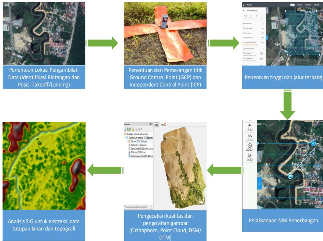
Gambar 4. Alur pengumpulan data menggunakan UAV
