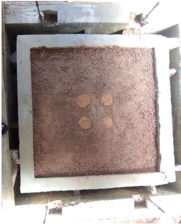
Lampiran 15. Dokumentasi pengujian kolom kapur pada bak uji dengan alat shallow mixing
