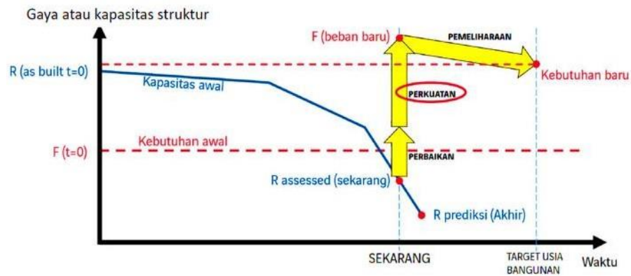
Gambar 11. Konsep perbaikan dan perkuatan struktur
