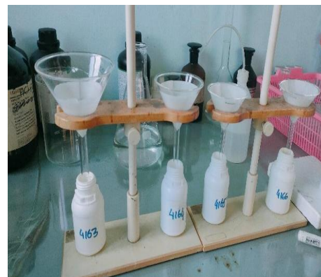
Disaring dengan kertas whatman dan filtrat yang diperoleh kemudian siap dianalisis menggunakan ICP-OES
