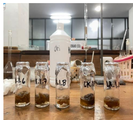
Sampel Setelah di timbang dan penambahan larutan KOH
