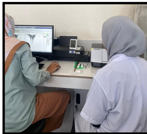
Identifikasi jenis polimer mikroplastik dengan uji FT-IR
