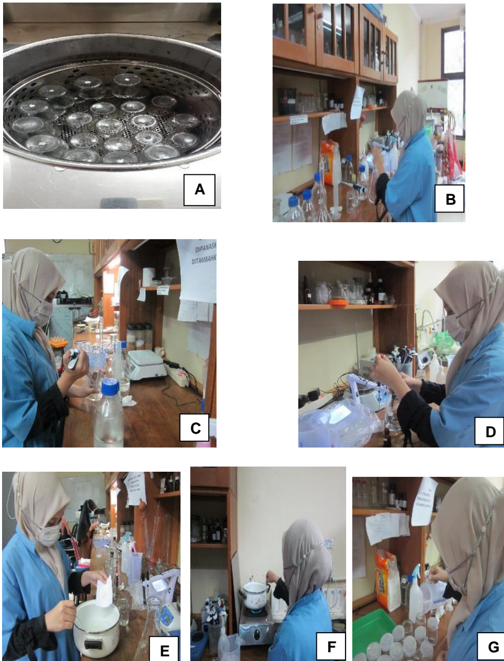
Gambar Lampiran 3. Proses pembuatan media: (a) Sterilisasi botol kultur (b) Mencampurkan larutan stok MS dengan aquades dan gula (c) Pemberian ZPT BA dan NAA (d) Pengukuran pH 5.8 (e) Pemberian agar-agar (f) memanaskan larutan media (g) Penuangan media pada botol kultur steril.
