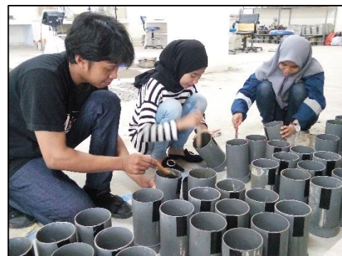
Pengolesan oli pada bekisting
