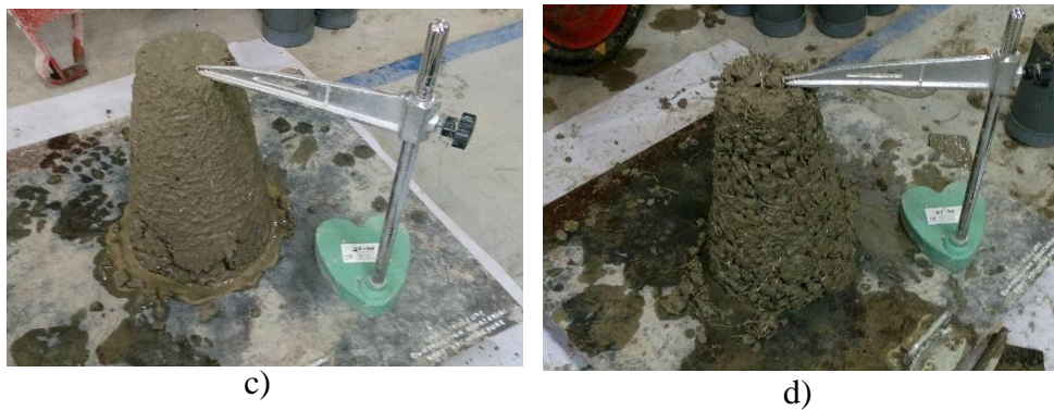
Gambar 10. Hasil Tes Slump beton ; a). Beton Normal, b). Beton + Serat Kaleng 5%, c). Beton + Serat kaleng 5%, d). Beton + Serat kaleng 7.5%
