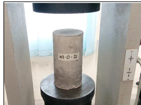
Pengujian kuat tekan (Sebelum ditekan)
