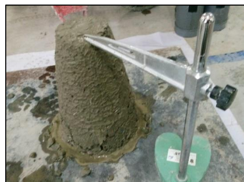
Pengujian Nilai Slump
