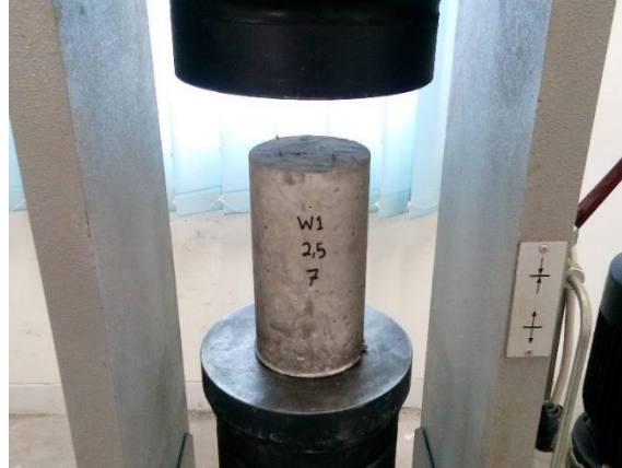
Gambar 13. Pengujian kuat tekan menggunakan alat UTM
