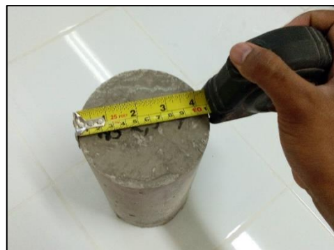
Pengukuran diameter benda uji
