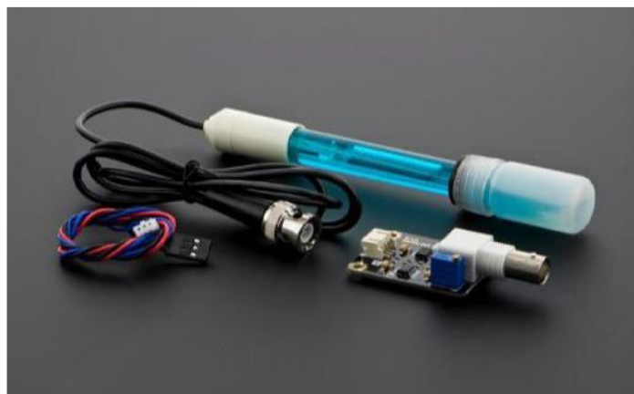
Gambar 4 Sensor pH SEN0161 (Karangan dkk, 2019)
