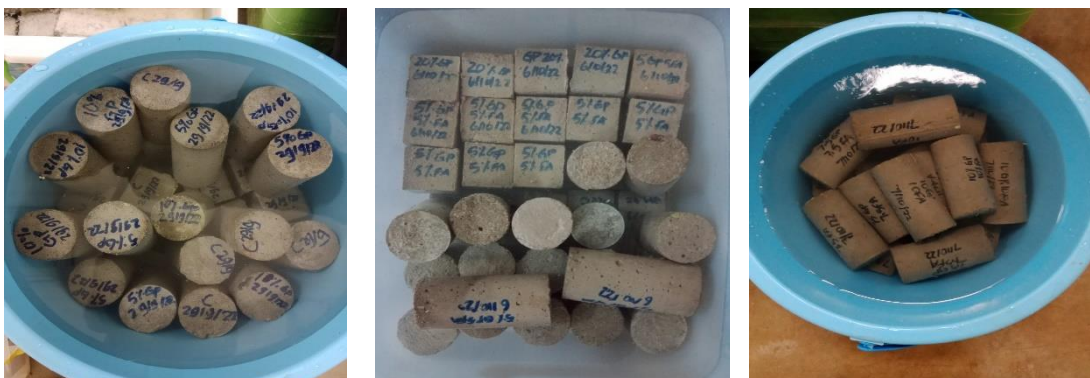
Lampiran 7. Dokumentasi Perawatan ( Curing ) Benda Uji
