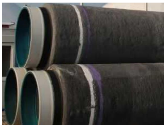
Gambar 19 Coating pada pipa bawah laut
