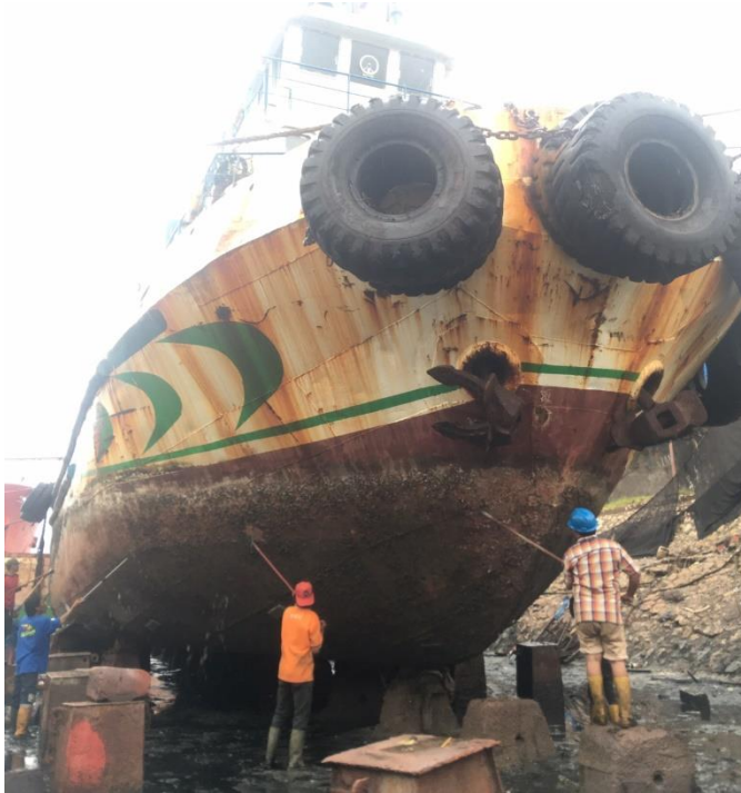
Gambar scraping pada badan kapal
