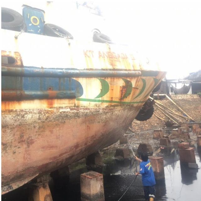
Gambar cuci air tawar pada badan kapal
