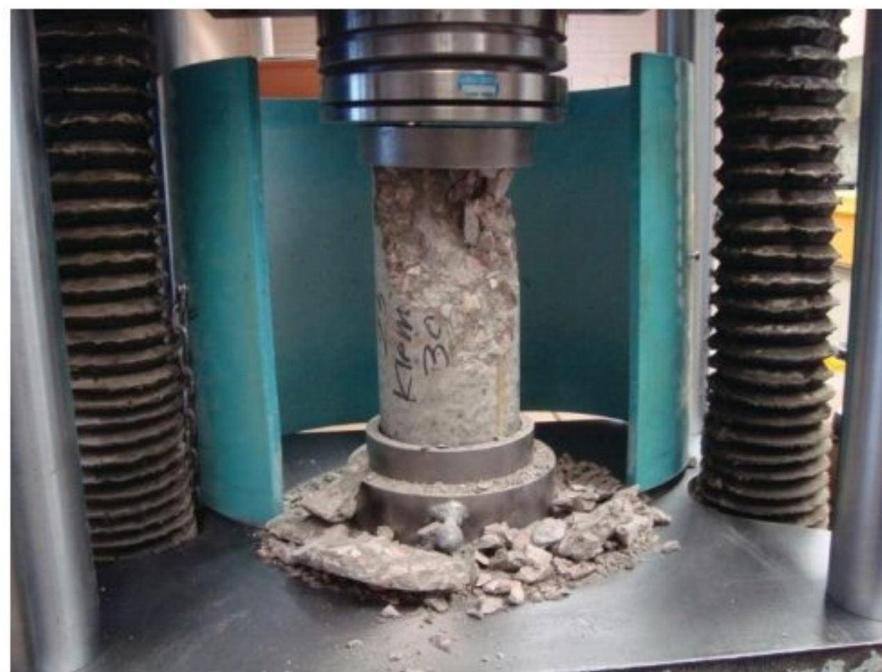
Gambar 2.9. Proses pengujian kuat tekan beton
