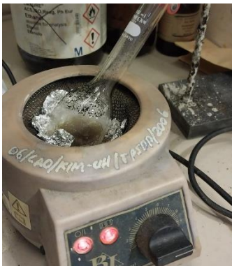
Proses destruksi (analisis kadar protein metode Kjeldahl)
