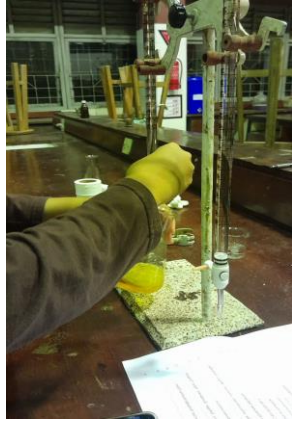
Proses titrasi (analisis kadar protein metode Kjeldahl)
