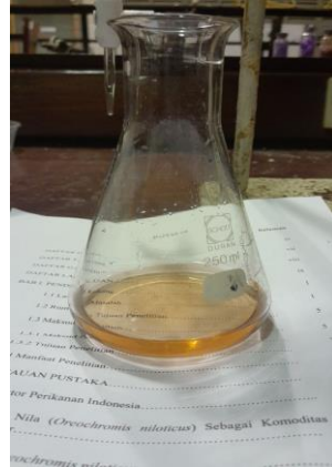
Hasil titrasi (analisis kadar protein metode Kjeldahl)
