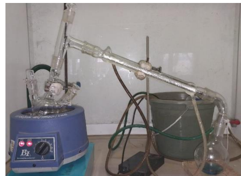
Proses distilasi (analisis kadar protein metode Kjeldahl)
